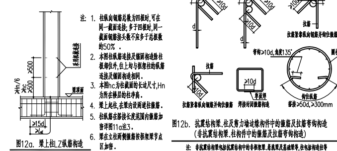
图12a. 梁上柱纵筋构造
