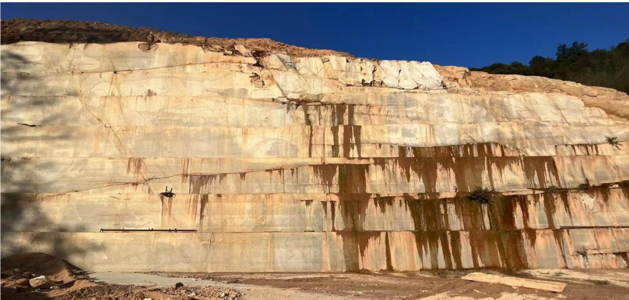
照片 1 裂隙率统计采场断面
